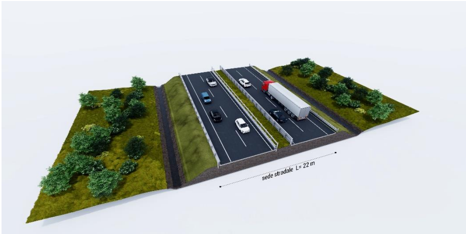
Figura 3-2 – Sezione tipo strada di categoria “B”
