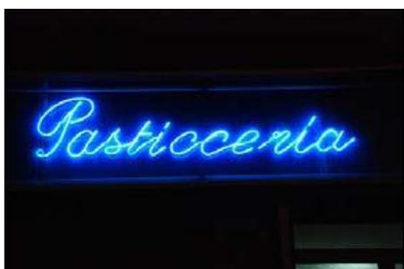
**filamento neon:** trattasi di tubi fluorescenti piegati a caldo. Con questa tecnica vengono realizzate sia scritte che disegni. Ammesse solo al piano terra. Ammesse ad un solo file. **Zone in cui sono ammesse: I Zona (ad esclusione della zona "A" P.R.G. vigente), II Zona, III Zona, IV Zona, V Zona.**
